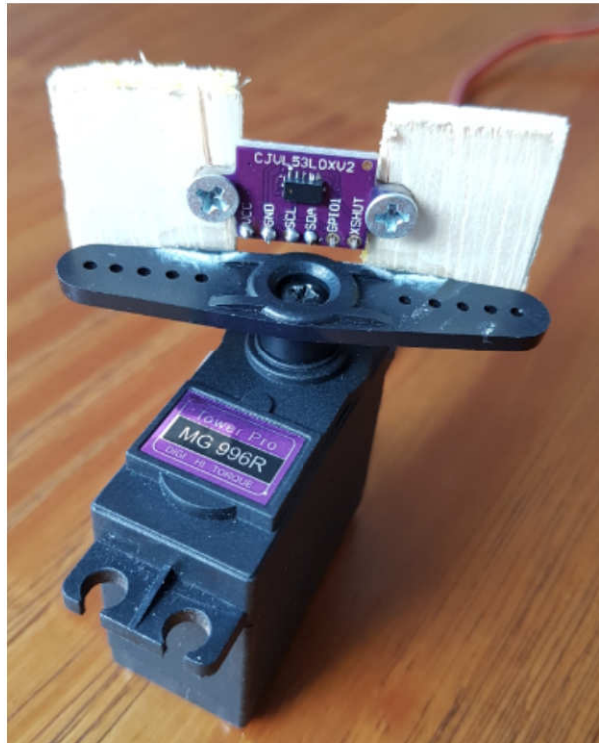
Figura 54: Montagem do sensor LIDAR sobre o servomotor.
