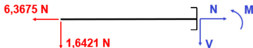
Figura 38: Esforços na cantoneira para o trecho AP.
