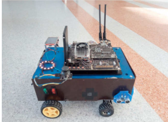
Figura 8: Robô autônomo desenvolvido para rastrear animais de estimação e evitar serem pisados [Chrzahowski et al., 2019].
